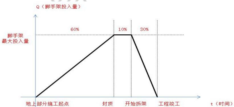
脚手架搭拆和使用的时间规律示例图
